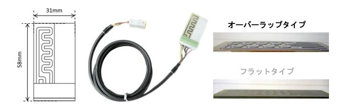
写真は炭素鋼を用いた標準サイズのセンサとなります。お客様のご要望にあわせて金属材料、電極形状を変更することを可能としています。また、曲面などに密着させて設置・計測するために基板を薄型化、めっき材料に対応するために電極面をフラットにしたタイプもございます。
