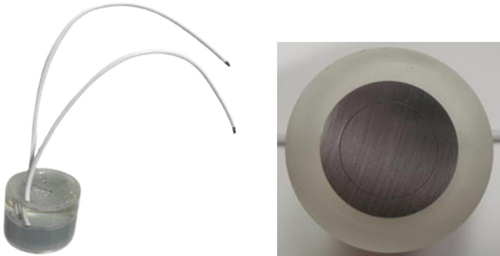
円状電極とリング状電極にリード線を接続。電極間距離を  $100\mu\text{m}$  としエポキシ樹脂で埋め込んでいます。すきま腐食を抑制するため電極側面は電着塗装を施しています。
